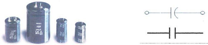
Gambar - 18 Simbol dan Fisik Kapasitor ( www.Slideshare.net )
