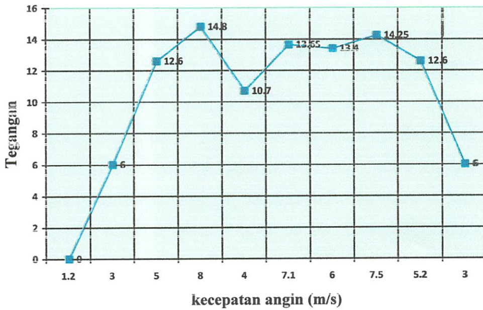
Grafik 4.2 hubungan tegangan output generator terhadap kecepatan angin, sebelum dihubungkan dengan baterai
