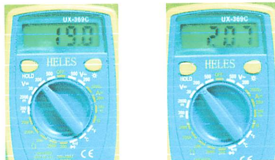
Gambar. 4.4 Pengukuran tegangan sebelum dipasang baterai pada solar cell
