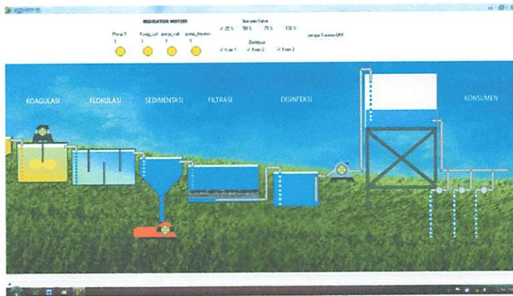
Gambar 4.46 Kondisi Dihidupkan Tiga Keran (outputan) Dengan Bukaan Valve sebesar 25%
