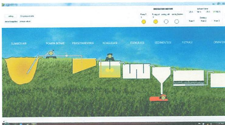
Gambar 4.38 Kondisi Pengoprasian Motor Koagulasi Saat Instruksi Push Button Motor Koagulasi Ditekan
