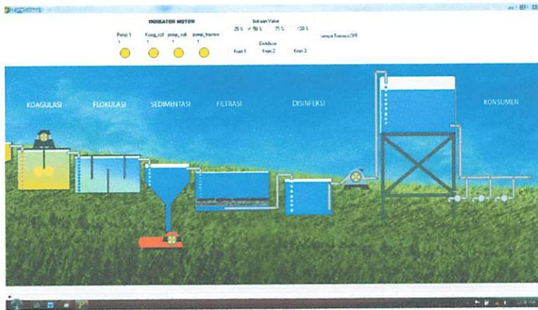
Gambar 4.42 Kondisi Pengoperasian Pompa Transmisi Saat Instruksi Push Button Pompa Transmisi Ditekan Dengan Bukaan Valve Sebesar 50%
