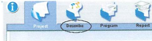
Gambar 2.12 Pilih 'Describe' untuk Setting PLC
