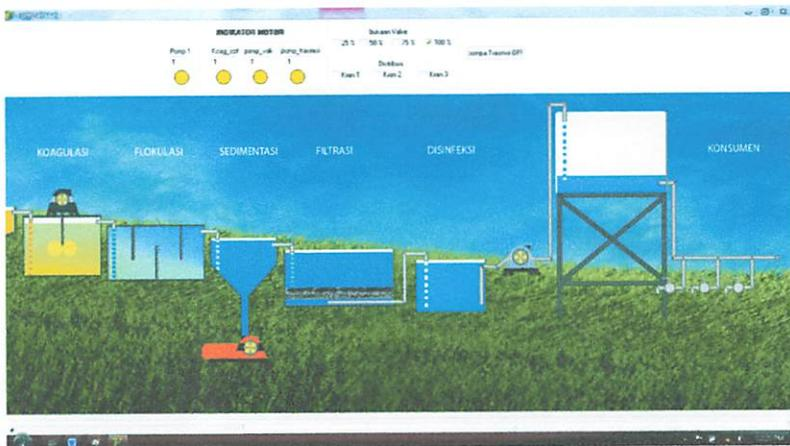
Gambar 4.40 Kondisi Pengoperasian Pompa Transmisi Saat Instruksi Push Button Pompa Transmisi Ditekan dan Buka an Valve sebesar 100%
