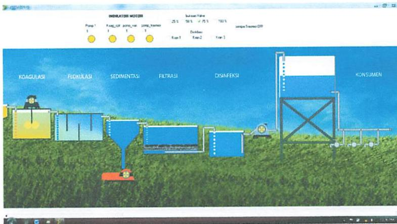
Gambar 4.41 Kondisi Pengoperasian Pompa Transmisi Saat Instruksi Push Button Pompa Transmisi Ditekan Dengan Buka an Valve sebesar 75%
