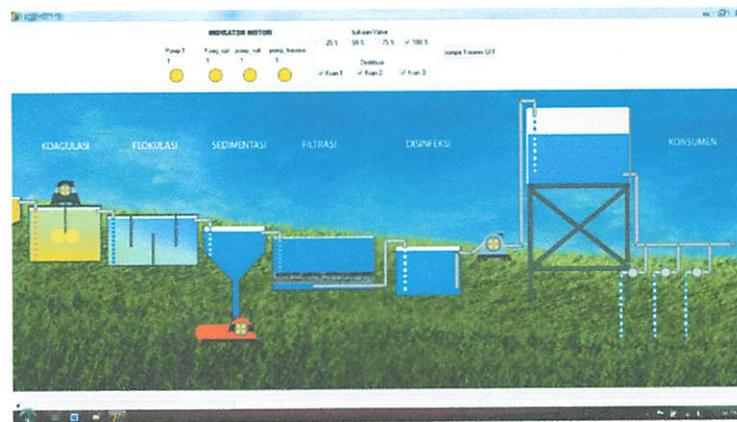
Gambar 4.47 Kondisi Dihidupkan Tiga Keran (outputan) Dengan Bukaan Valve sebesar 100%
