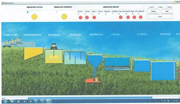
Gambar 4.33 Simulasi Semua Proses Produksi Berhenti Ketika Kondisi Persediaan Air Bersih Penuh
