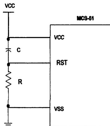
**Gambar 2.10** Rangkaian Power On Reset<sup>[2]</sup>
