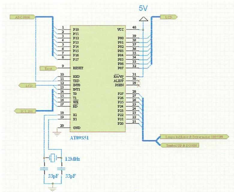
**Gambar 3.6 Rancangan Pemakaian Port-Port Mikrokontroler AT89S51**
