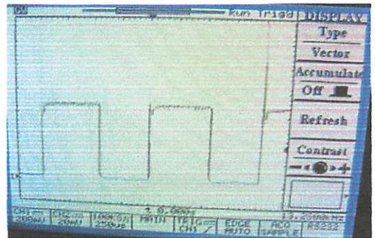
d) Gambar 4.5 pada Osciloscop Sinyal 45%
