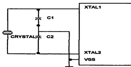
**Gambar 2.11** Rangkaian Pewaktuan dengan Osilator Internal<sup>[2]</sup>
