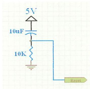
**Gambar 3.7 Rangkaian Reset Pada Mikrokontroler AT89S51**
