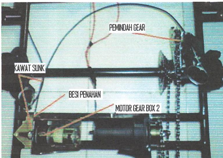
**Gambar 3.15** Perancangan Motor Gear box 2
