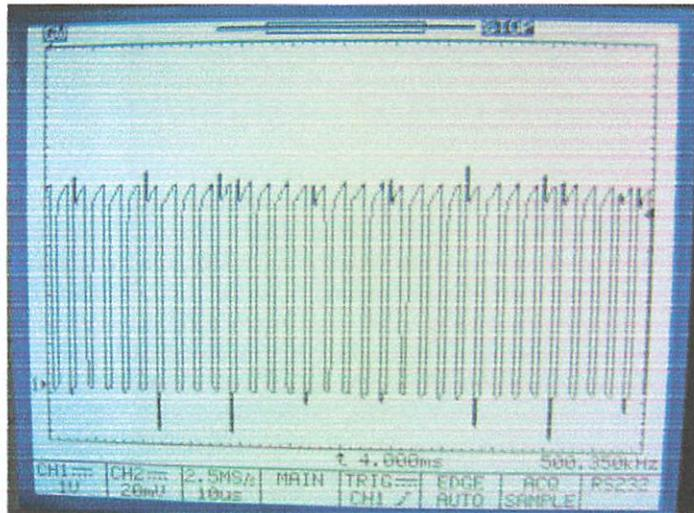
**Gambar 4.28** Frekuensi Yang Keluar Dari Ic LM 555
