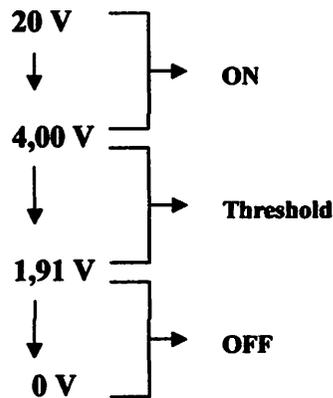
**Gambar 3.8 Tegangan Off, Threshold, dan On**
