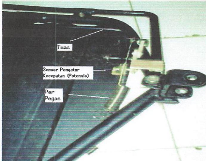
**Gambar 3.2 Hubungan Sensor Pengatur Kecepatan (Potensio) Dengan Tuas**
