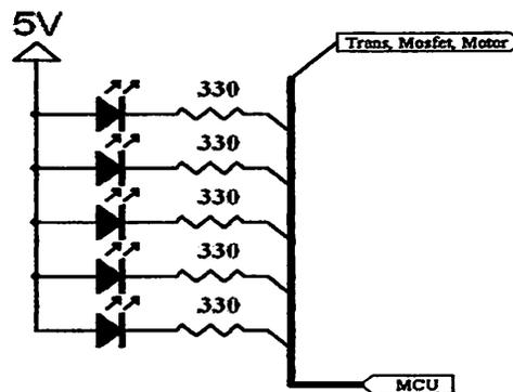
Gambar 4.24 Rangkaian Lampu Indikator
