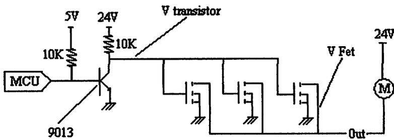
**Gambar 3.9** Transistor 9013 dan Mosfet Irzf 44n
