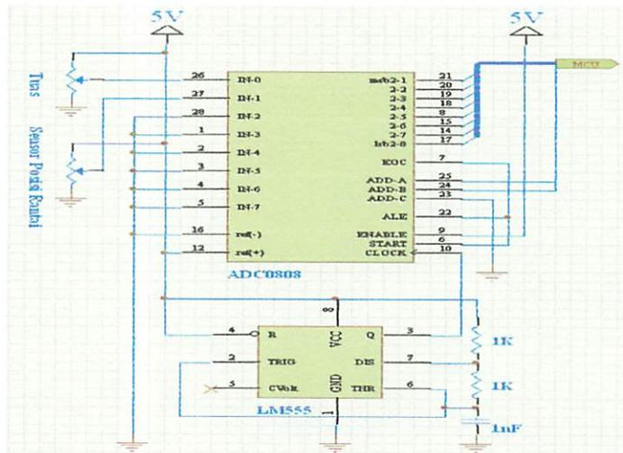
**Gambar 3.3 Rangkaian Sensor Pengatur Kecepatan (Potensio)**
