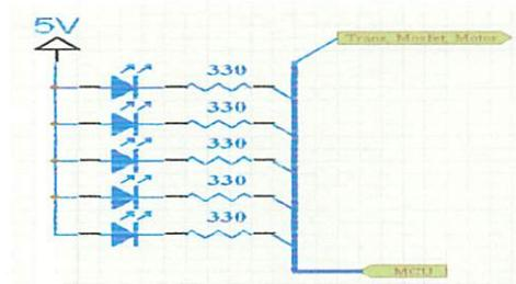
Gambar 3.19 Rangkaian Lampu Indikator
