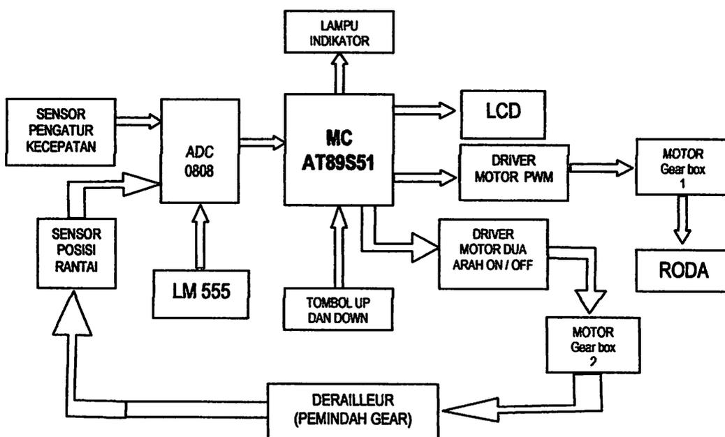
Gambar 3.1 Blok Diagram Sistem Pengendali Gokart
