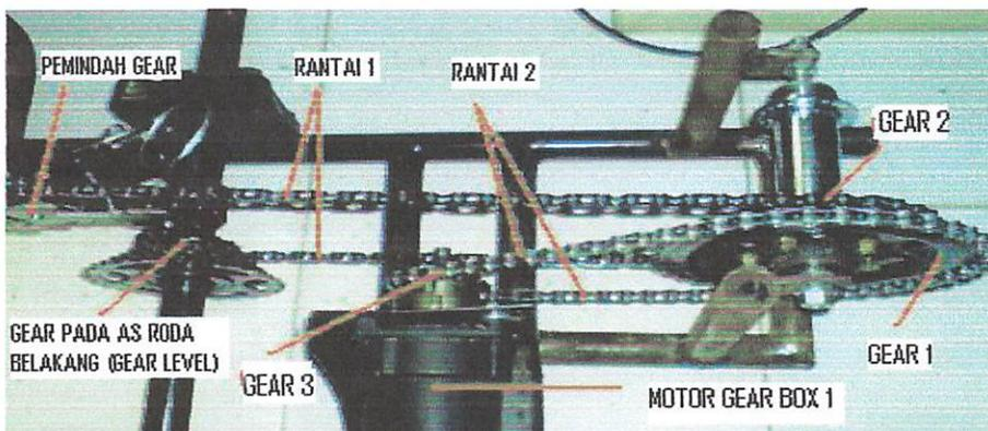
Gambar 3.11 Perancangan Motor Gear Box 1
