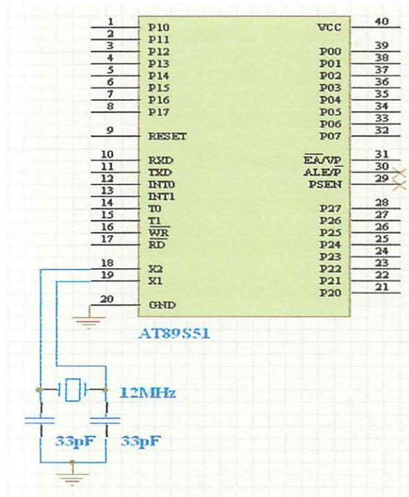
Gambar 3.5 Rangkaian Minimum Sistem Mikrokontroler
