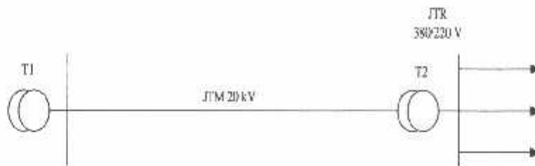
Gambar 2-3 Bentuk sederhana dari sistem distribusi radial [2]
