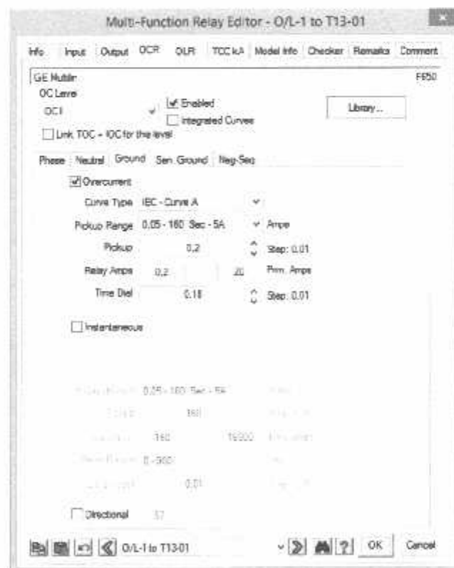
Gambar 4.21 Kondisi Awal Pada Data Rele sisi 11 kV ( ground ) di PT. KPC.
