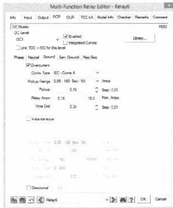
Gambar 4.23 Kondisi Awal Pada Data Rele sisi 11 kV ( ground ) di PT. KPC.
