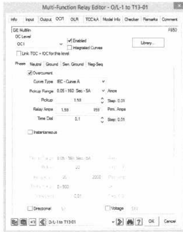
Gambar 4.20 Kondisi Awal Pada Data Rele sisi 11 kV ( phase ) di PT. KPC.
