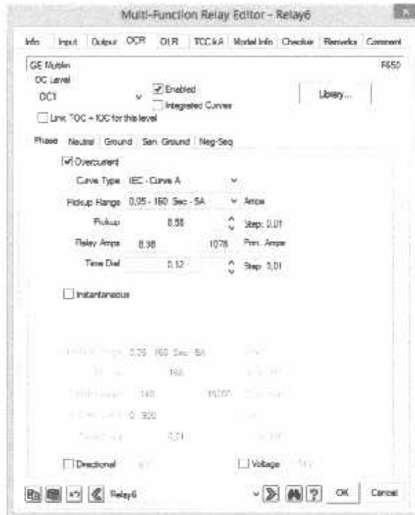
Gambar 4.22 Kondisi Awal Pada Data Rele sisi 3,4 kV ( phase ) di PT. KPC.
