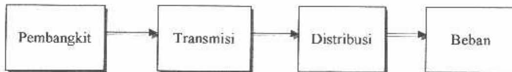
Gambar 2.1 Garis Besar Proses Penyaluran Tenaga Listrik
