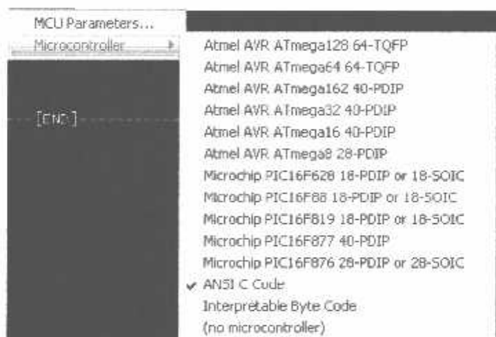
Gambar 2.15 Mikrokontroler yang Support Program LdMicro
