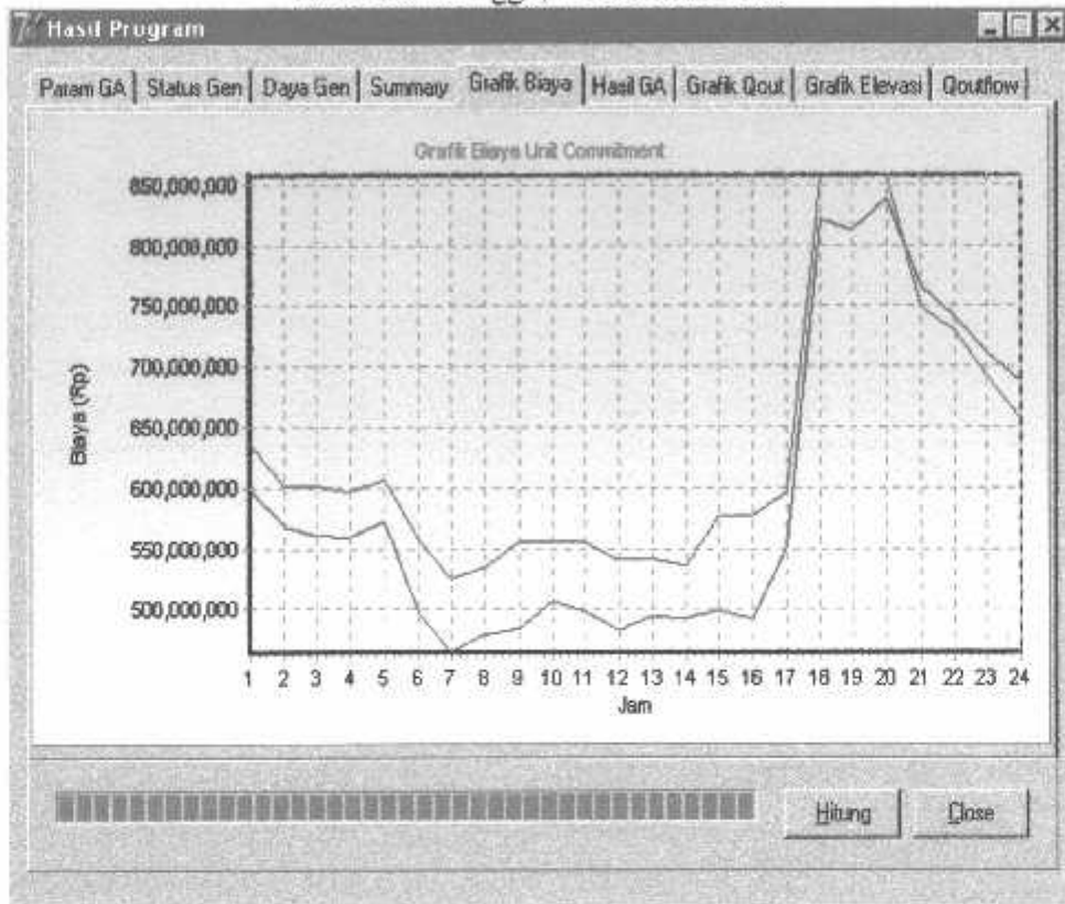
Grafik 4 – 28 Kurva Biaya Operasional P1. PJB dan Metode Genetic Algorithm Pada Hari Minggu, 7 Desember 2003
