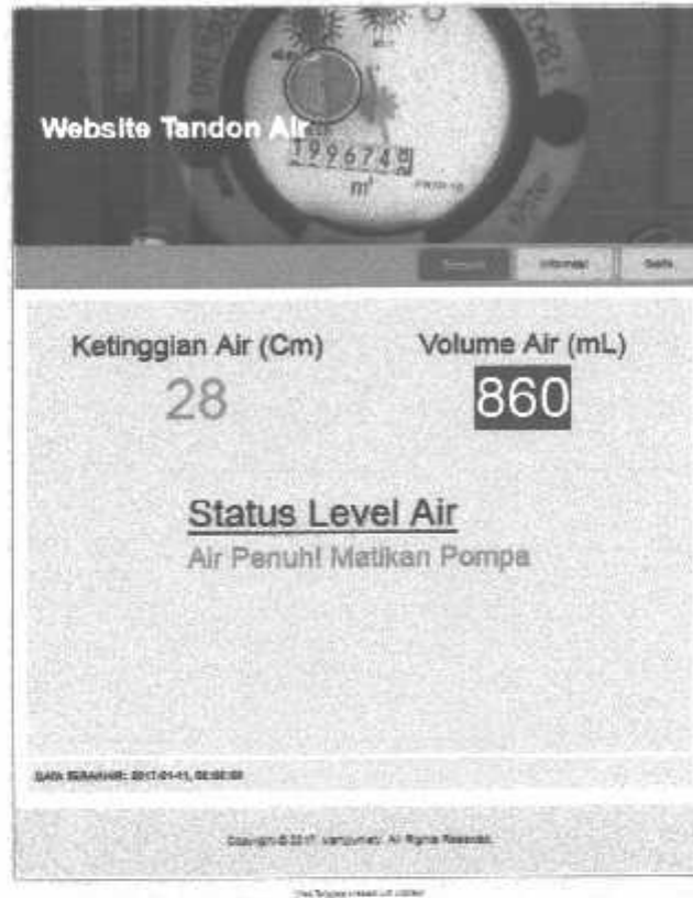
Gambar 4.11 Air Tandon Dalam Kondisi Penuh
