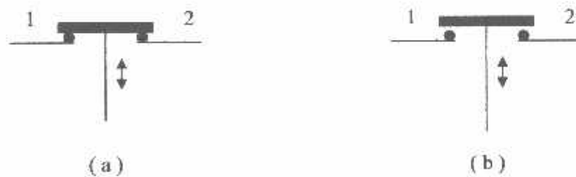
Gambar 3.2 Diagram Skematik Tipe (a) NC switch dan (b) NO switch
