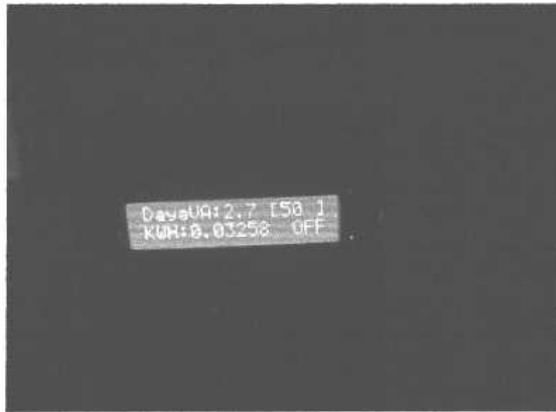
Gambar 4.18 Hasil Pengujian daya dan KWH pada kamar
