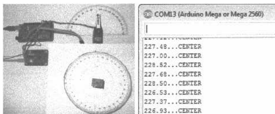
Gambar 4. 3 Motor Servo 90° Data Kompas 180° - 240°.
