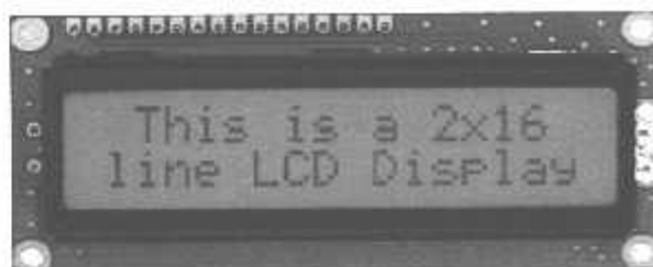
Gambar 2.10 Tampilan fisik LCD 16x2
