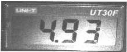
Gambar 4.10 Tegangan output pada pin arduino untuk fungsi relay
