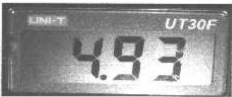
Gambar 4.8 pengukuran pada pin 13 arduino
