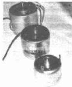
Gambar 2.14 Bentuk Fisik Motor DC dalam Berbagai Ukuran
