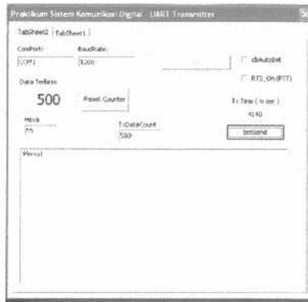
Gambar 4.47 Pengiriman karakter U dengan menggunakan baudrate 1200 bps dengan Noise
