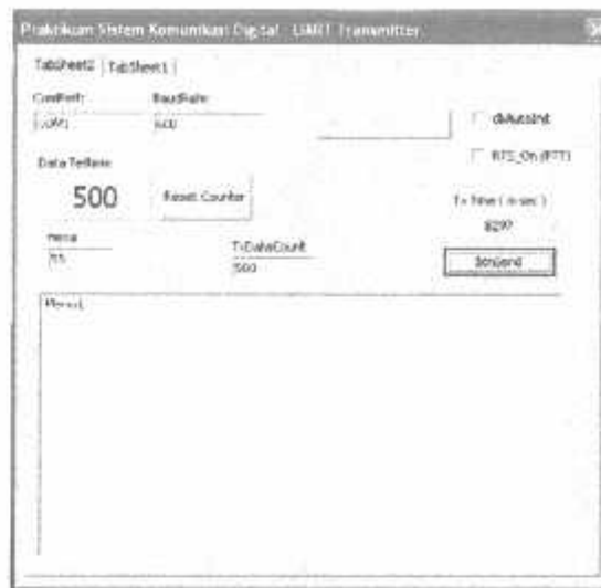
Gambar 4.37 Pengiriman karakter U dengan menggunakan baudrate 600 bps
