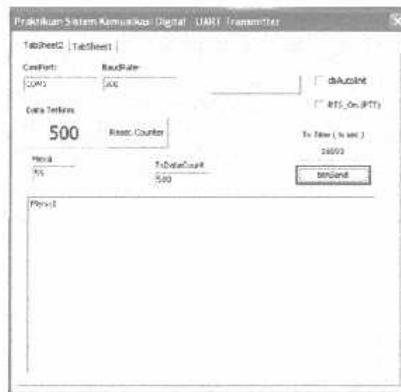
Gambar 4.35 Pengiriman karakter U dengan menggunakan baudrate 300 bps
