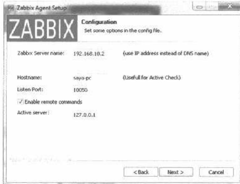
Gambar 4.51 Instalasi Zabbix Agent Langkah keempat
