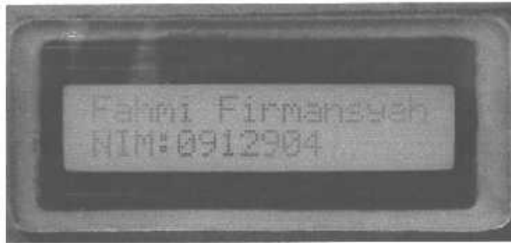
Gambar 4.5 Hasil Pengujian Antarmuka Modul LCD
