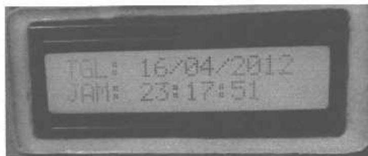
Gambar 4.7 Hasil Pengujian Rangkain RTC
