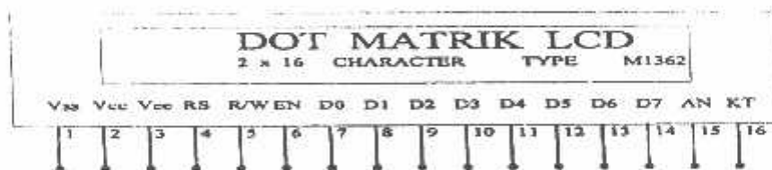
Gambar 2-10 Deskripsi pin pada LCD Tipe M1362
