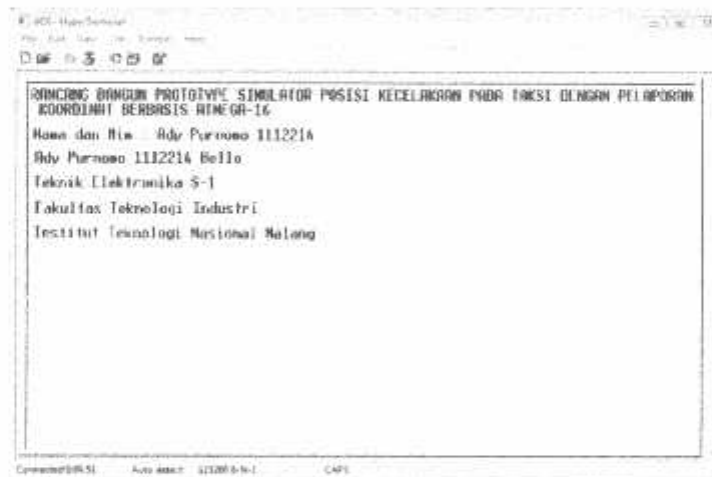
Gambar 4.7 Hasil Pengujian Ketika Hyperterminal Menerima Data Serial Berupa Nama dan Nim Dengan Tambahan Hello.
