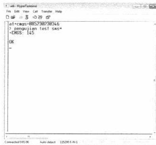
Gambar 4.4 Tampilan Respon Modem Saat Mengirimkan SMS
