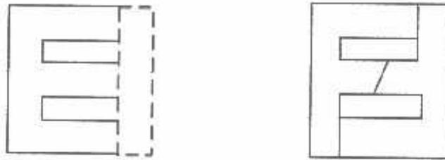
Gambar. 2.4. Konstruksi lempengan logam inti transformator bentuk E, I dan F
