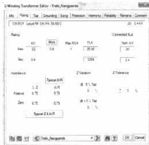
Gambar 3.7. input Rating Penyulang Nangapanda
