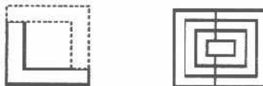
Gambar. 2.2 Konstruksi lempengan logam inti transformator bentul L dan U
