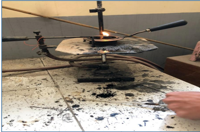
Pengujian Titik Nyala Dan Titik Bakar
