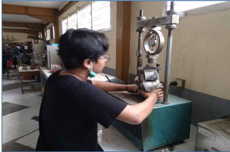
Pemasangan Benda Uji Ke Alat Marshall
