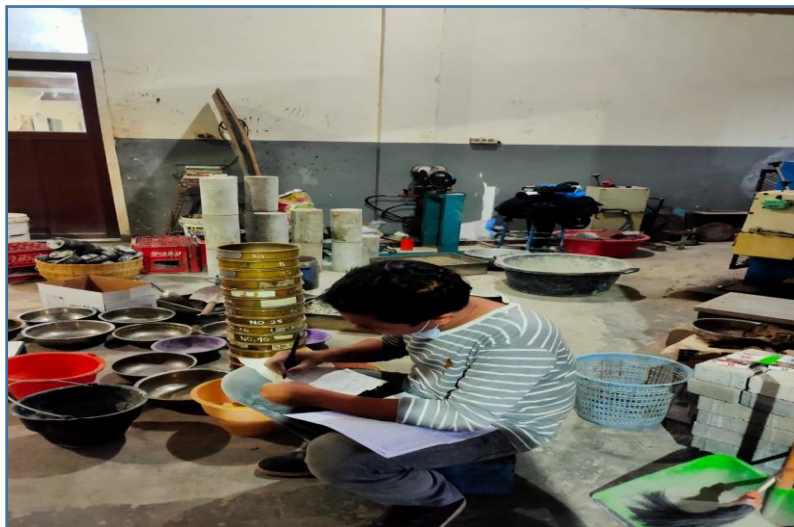
Pengujian Analisa Saringan Agregat
