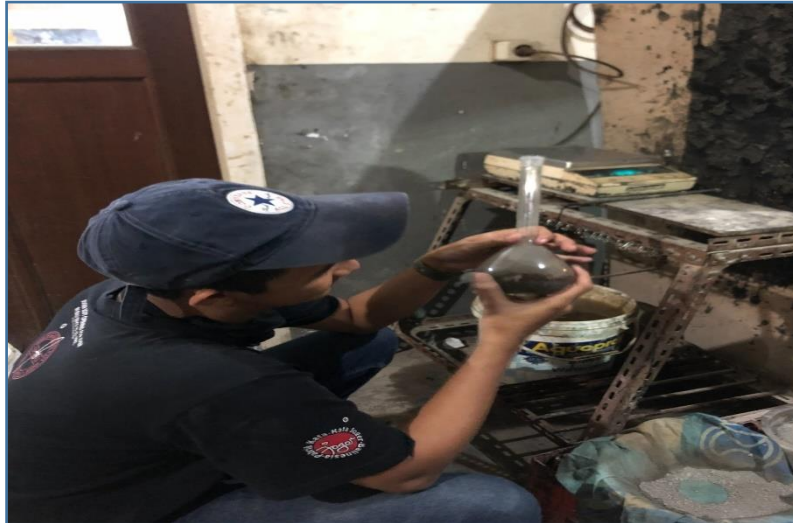
Pengujian Berat Jenis Agregat
