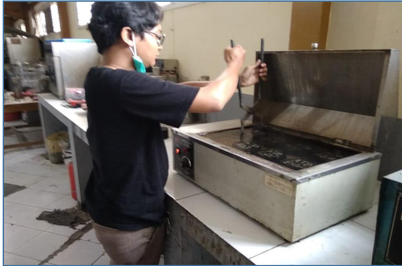
Proses Memasukan Benda Uji Ke Dalam Waterbath
