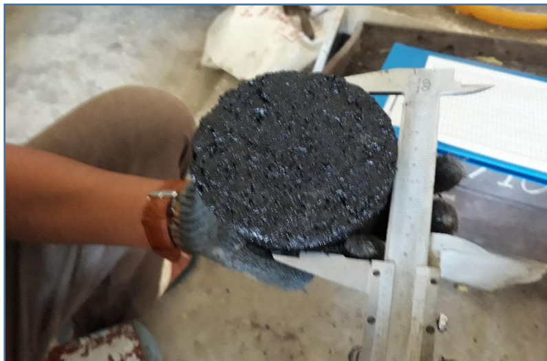
Pengukuran Diameter Benda Uji
