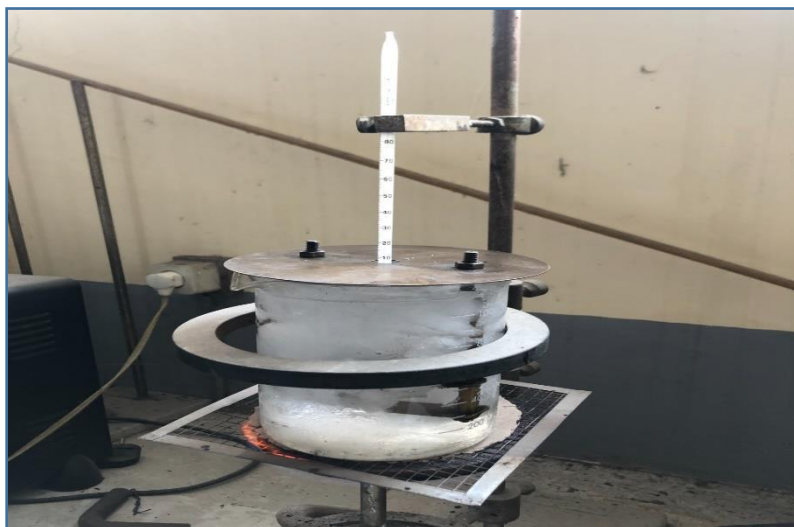
Pengujian Titik Lembek Aspal Dan Ter
