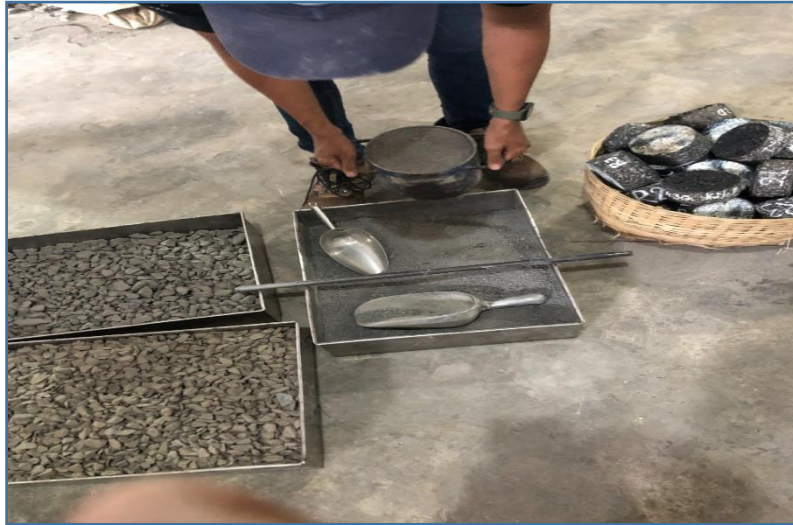
Pengujian Berat Isi Agregat
