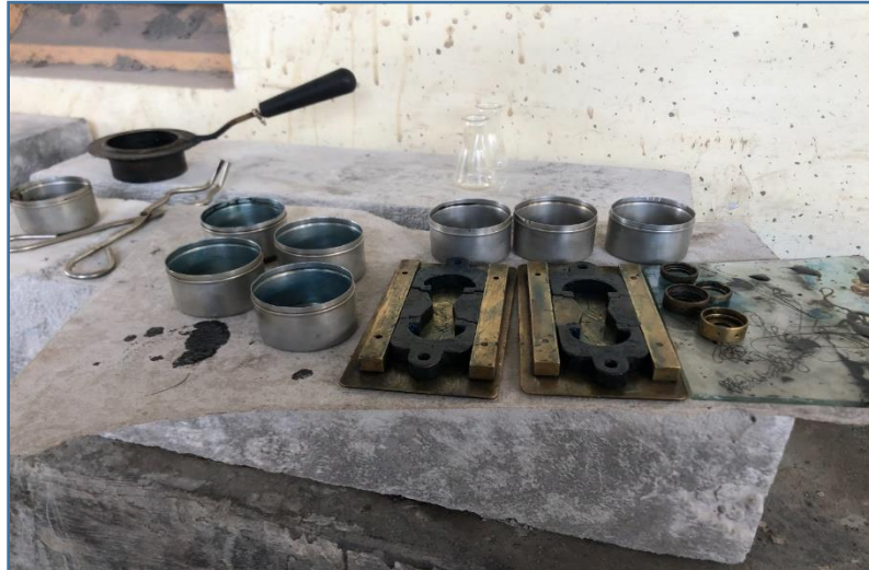
Cetakan Untuk Pengujian Aspal
