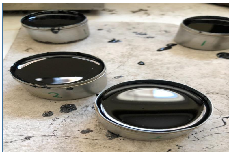
Aspal Setelah Dituang Ke Dalam Cetakan
