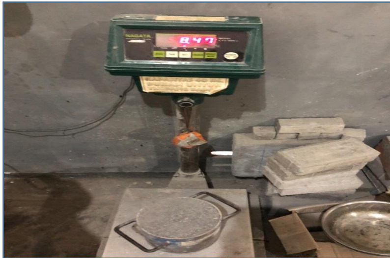
Penimbangan Agregat Untuk Pengujian Berat Isi
