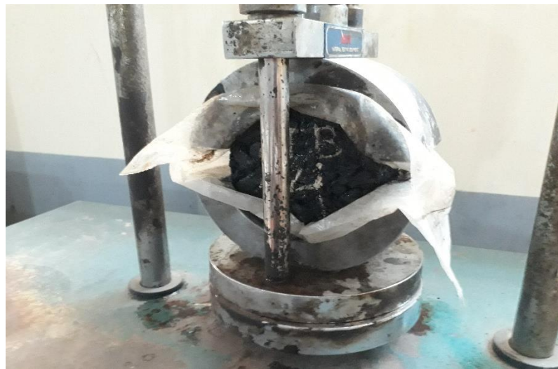
Pemasangan Benda Uji Ke Alat Marshall
