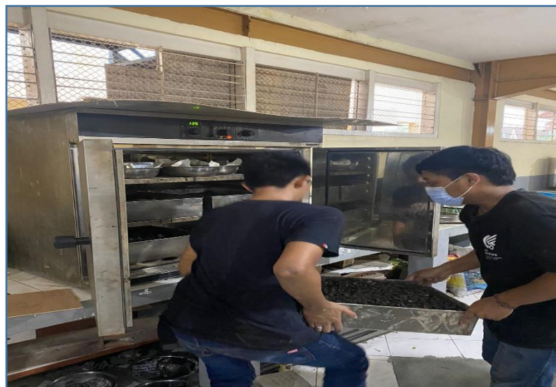
Memasukan Agregat Ke Dalam Oven Untuk Pengeringan
