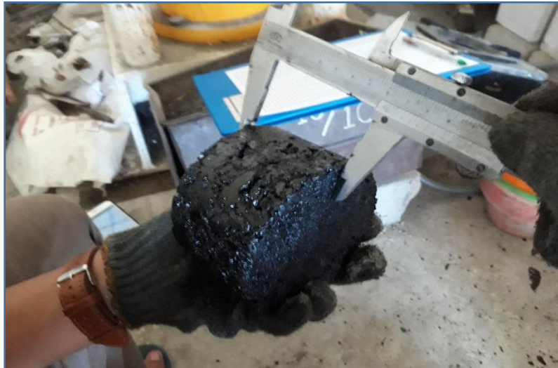
Pengukuran Ketebalan Benda Uji
