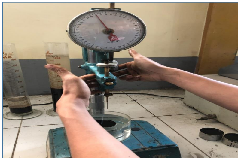
Pengujian Penetrasi Aspal
