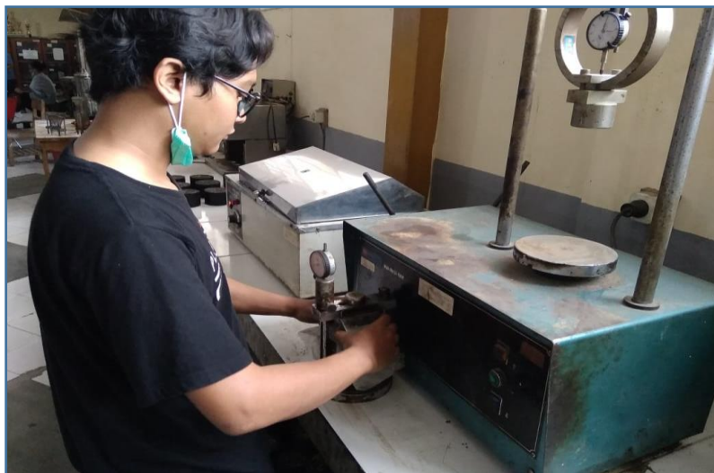
Persiapan Pengujian Marshall
