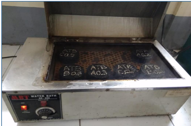
Perendaman Benda Uji Di Waterbath
