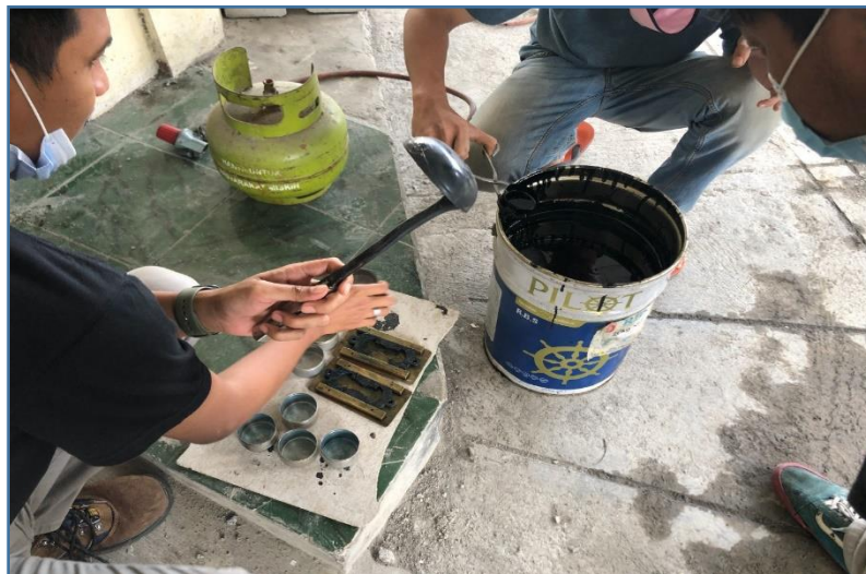
Penuangan Aspal Cair Ke Dalam Cetakan
