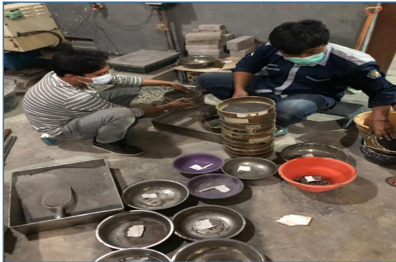
Pengujian Analisa Saringan
