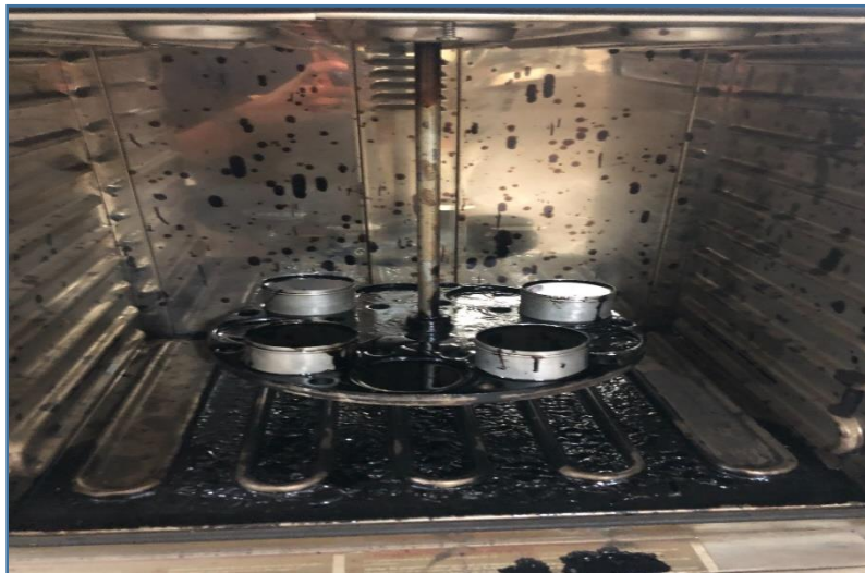
Pengujian Penurunan Berat Minyak Aspal
