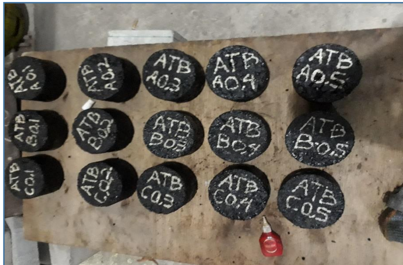
Hasil Benda Uji Yang Sudah Di Padatkan
