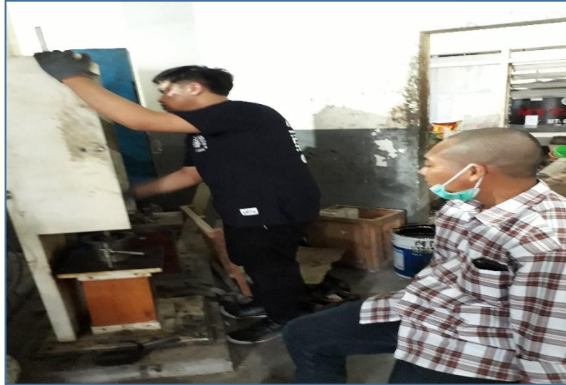
Proses Pemadatan Benda Uji
