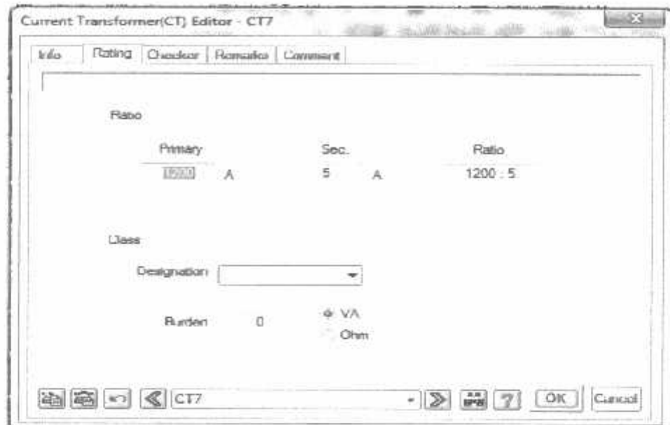
Gambar 3.8 Input Parameter Current Transformer di ETAP Powerstation
