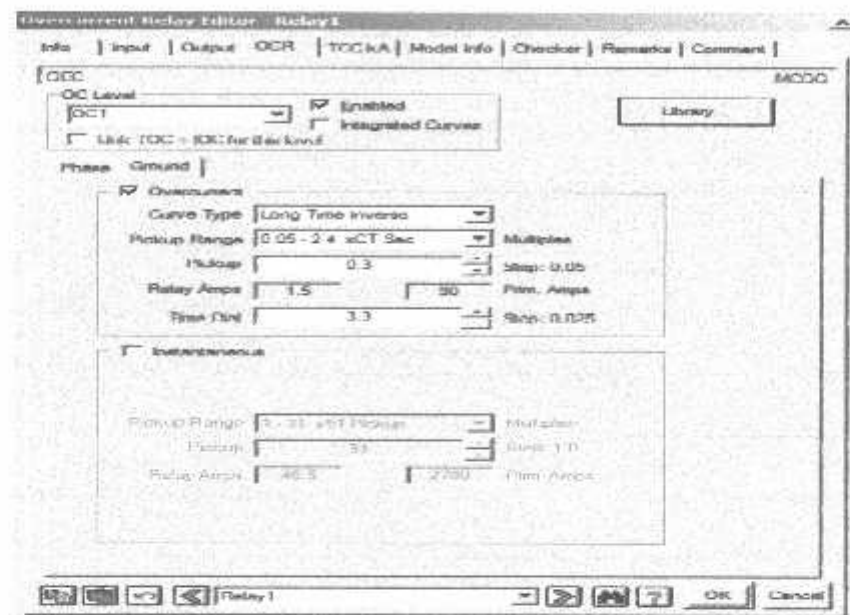
Gambar 4.15 Input Parameter Setelah Resetting Relay 1 GFR ( ground fault relay ) Tipe MCGG
