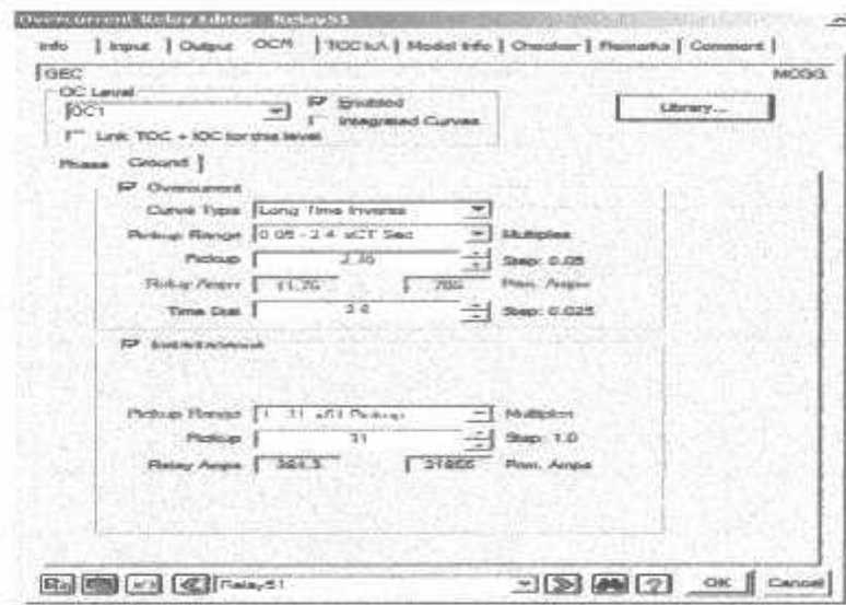
Gambar 4.17 Input Parameter Setelah Resetting Relay 51 GFR ( ground fault relay ) Tipe MCGG
