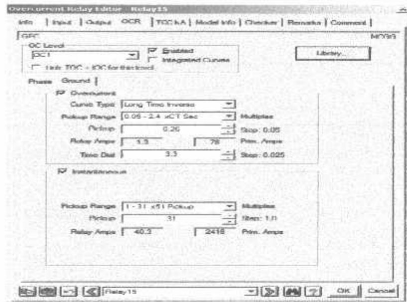
Gambar 4.19 Input Parameter Setelah Resetting Relay 15 GFR ( ground fault relay ) Tipe MCGG
