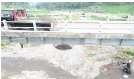
Gambar 3. Penambahan beban statis berupa pick up berisi muatan pasir
