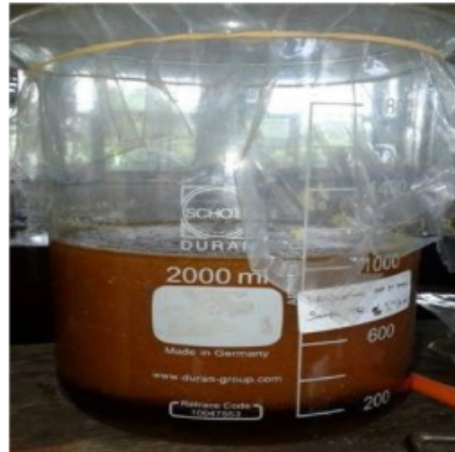
Gambar. 6.4. Proses delignifikasi secara kimia
