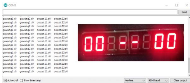
Gambar 4. 4. Seven segment dan sensor sebelum bola melewati garis gawang.
