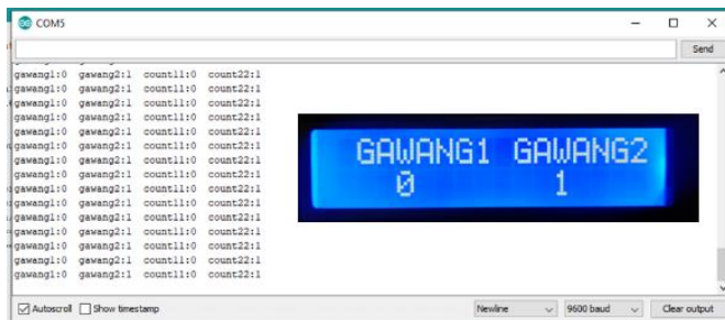
Gambar 4. 9. LCD Grafik 16x02 dan sensor sesudah bola melewati garis gawang 2.
