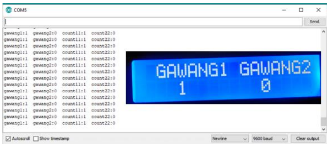
Gambar 4. 8. LCD Grafik 16x02 dan sensor sesudah bola melewati garis gawang 1.
