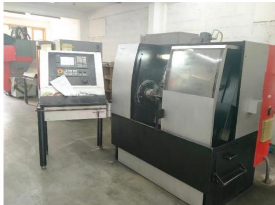
Gambar 3.6 Mesin Bubut CNC
