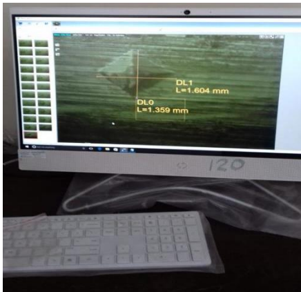
Pengujian : Titik Pengujian Vickers
