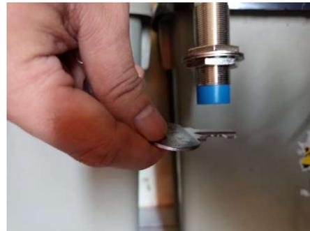
Gambar 17. Pengujian Induktif
