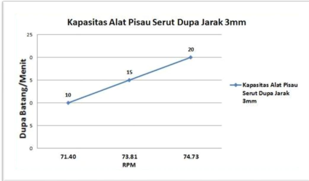
Gambar 4. 4 Grafik Pengujian Kapabilitas Alat Mata Pisau 3mm
