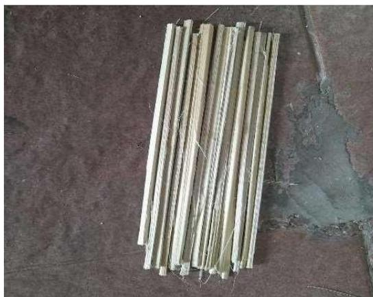
Gambar 4. 12 Hasil Pemotongan Pisau Serut Dupa 3mm dan 4mm
