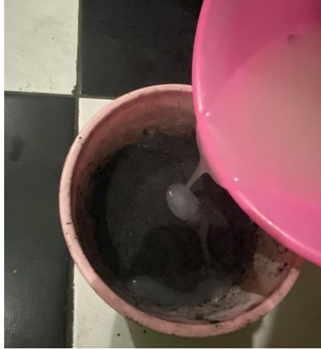
Gambar 3. 8 Pencampuran Perekat dan Serbuk Arang
