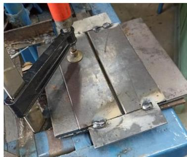
**Gambar 3.8. Posisi Pengelasan Pelat**
