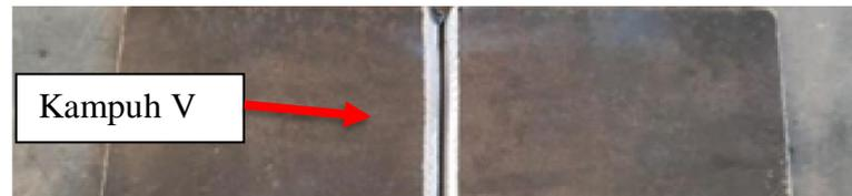
**Gambar 3.7. Hasil Pembuatan Kampuh v pada Baja AISI 4140**
