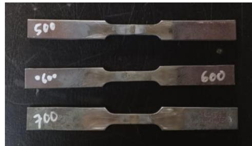
**Gambar 3.18. Hasil Spesimen Uji Mikro**
