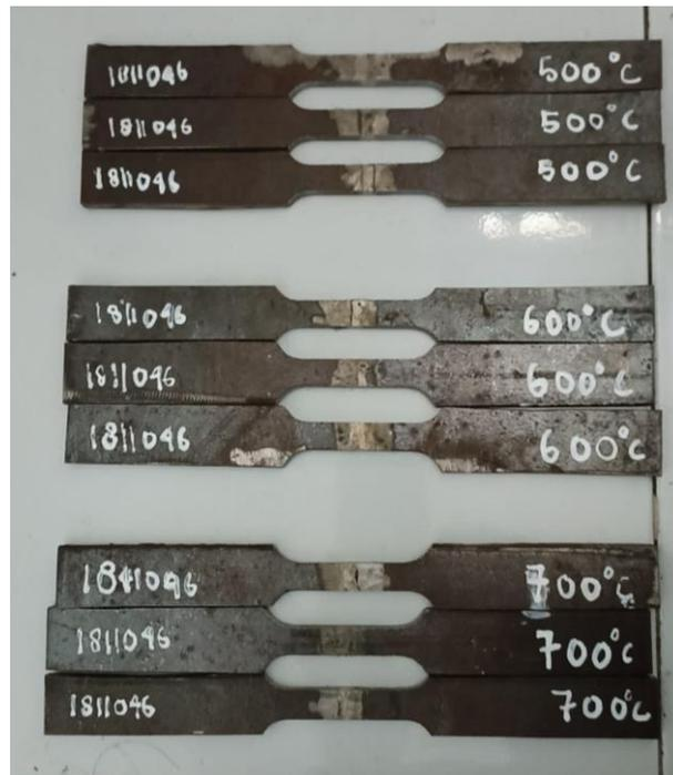
**Gambar 3.14. Spesimen Uji Tarik**
