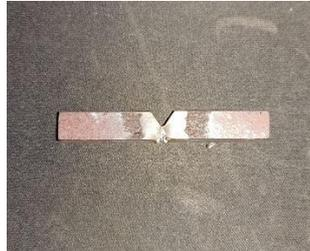
**Gambar 3.16. Spesimen Uji Impak**
