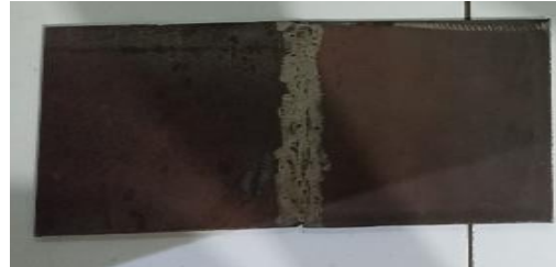
Hasil Las Tungsten Inert Gas
