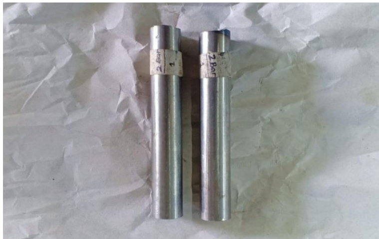
Gambar 2 Material Baja ST 42 yang sudah di potong.
