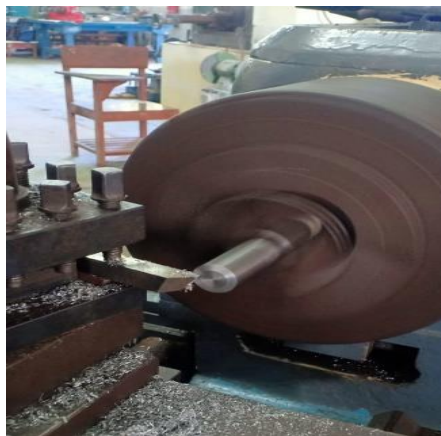
Gambar 3 Proses meratakan permukaan pada baja ST 42.
