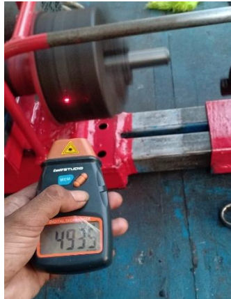
Gambar 4 Mengukur Putran Spindel menggunakan Tacometer.
