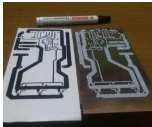
Gambar 3.6 “Pencetakan *Layout* PCB ke PCB polos”
