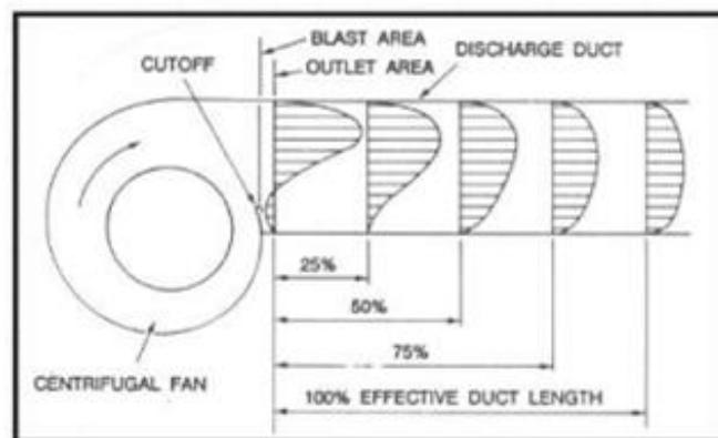
Gambar 3. Jarak pada outlet duct
