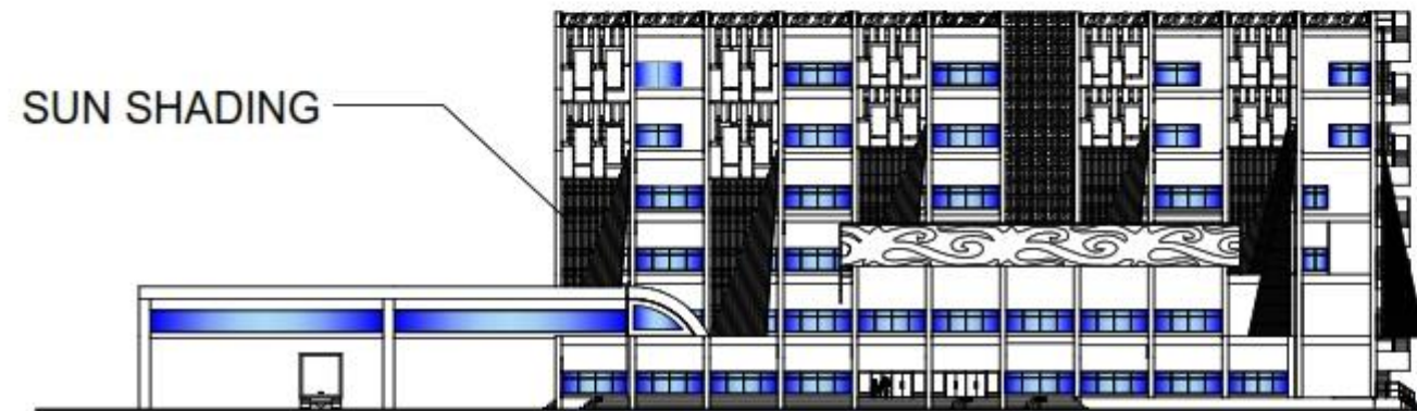
Penggunaan sunshading sebagai pencegah sinar matahari langsung masuk ke bangunan
