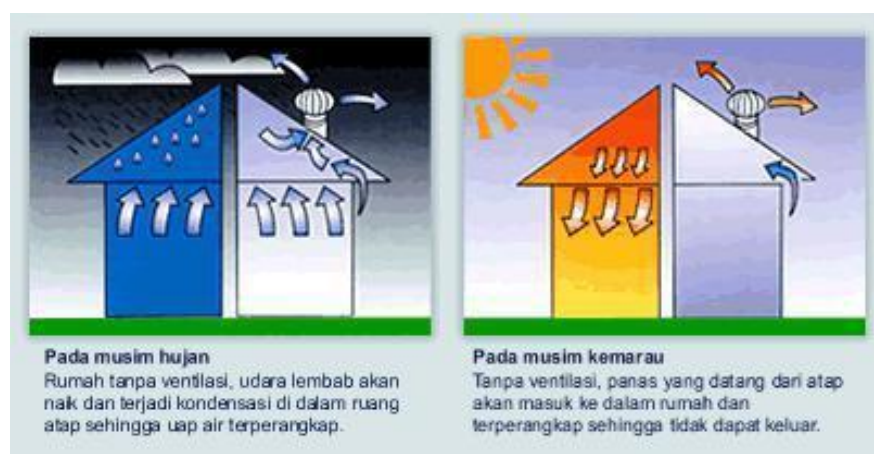
Gambar 2. 4 Mekanisme ventilasi udara dengan Turbin Ventilator
