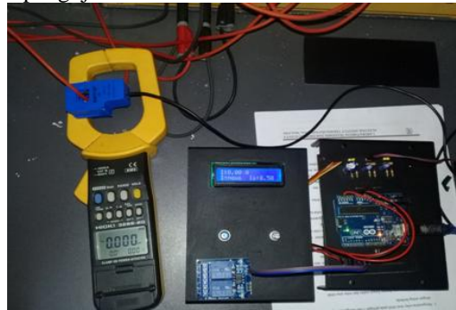
Gambar 4.6 OCR Karakteristik Definite Time Kondisi Tanpa Beban
