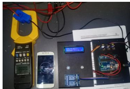
Gambar 4.9 OCR Karakteristik Normaly Inverse Kondisi Tanpa Beban
