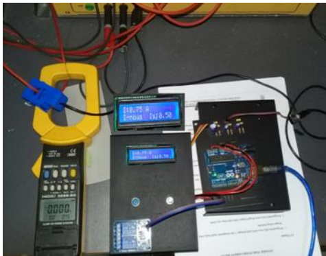
Gambar 4.5 OCR Karakteristik Instantaneous Kondisi Arus Lebih
