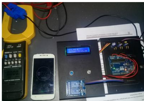
Gambar 4.12 OCR Karakteristik Normaly Inverse Beban 3R
