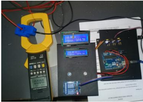
Gambar 4.4 OCR Karakteristik Instantaneous kondisi Tanpa Beban
