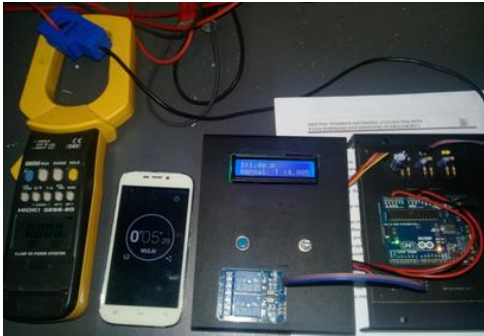
Gambar 4.11 OCR Karakteristik Normaly Inverse Beban R2
