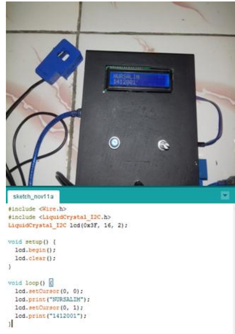
Gambar 4.1 Pengujian Liquid Crystal Display (LCD 16x2 I2C)
