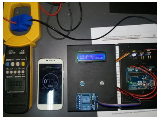
Gambar 4.7 OCR Karakteristik Definite Time Beban R2
