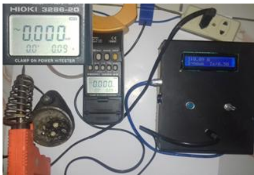
Gambar 4.3 Proses Kalibrasi SCT 013 (Sensor Arus) Program untuk Proses Kalibrasi SCT 013 (Sensor Arus)
