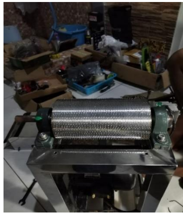
Pemasangan Silinder Pamarut
