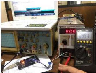
Gambar 25 Pengujian sensor tegangan
