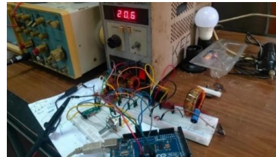
Gambar 27 Pengujian Cuk Converter
