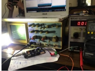
Gambar 24 Pengujian sensor arus
