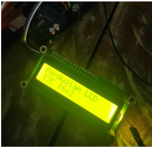
Gambar 3.7 Pengujian LCD 16x2 I2C
