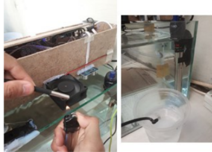
Gambar 4. 2 Pengujian Kendali Fan dan Heater
