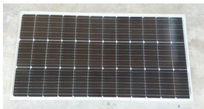
Gambar 10. Panel surya monocrystalline 100WP yang digunakan pada penelitian
