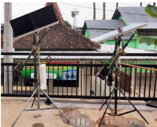
Gambar 4.3 Pengujian solar tracker dengan sekat panel surya dan solar tracker dengan sensor LDR
