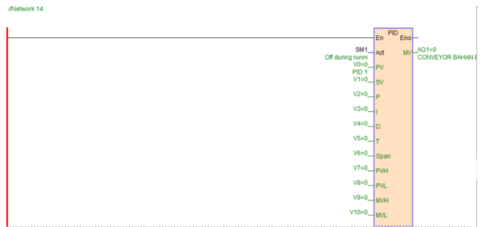
Gambar 4.11 kontrol PID sensor suhu
