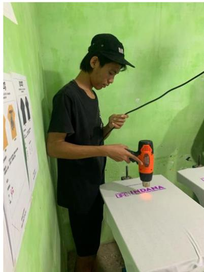
**Gambar 1.1** Pengeringan Tinta Sablon Menggunakan *Hot Gun* (Manual).
