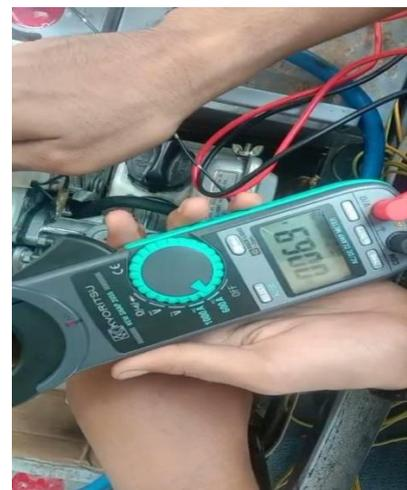
*Gambar 4. Pengukuran Arus*
