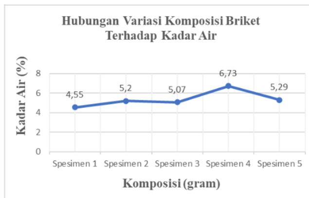
Berdasarkan pada grafik Hubungan Variasi Komposisi Briket Terhadap Kadar Air didapatkan hasil kadar air tertinggi sebesar 6,73% yang diperoleh dari spesimen 4 variasi komposisi 10 gr aval kain : 20 gr batok kelapa, 7,5 gr perekat dan 30 gr minyak jelantah, sedangkan kadar air terendah didapat dari spesimen 1, variasi komposisi 30 gr aval kain : 0 gr serbuk kayu, 7,5 gr perekat dan 30 gr minyak jelantah dengan nilai kadar air sebesar 4,55 %. Pada spesimen pertama dengan variasi
