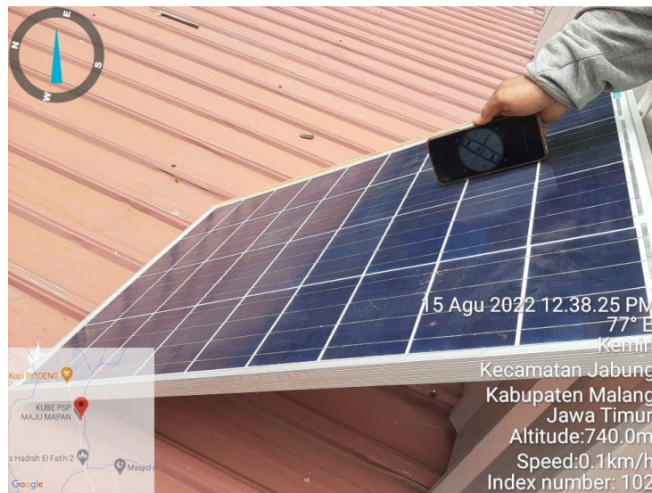
Gambar 4. 3 Pengukuran sudut kemiringan panel
